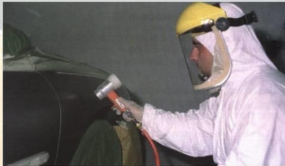
Las pinturas base agua, al tardar más tiempo en evaporar que los diluyentes, debemos acelerar esta evaporación con aire forzado, en este caso con sopladores de Efecto
