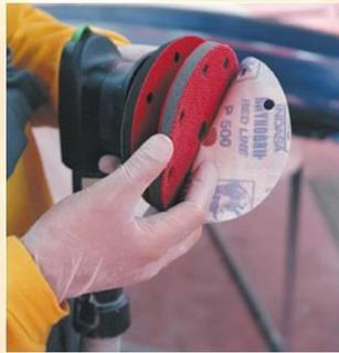
La operación de lijado se puede realizar, tanto al agua como en seco.
