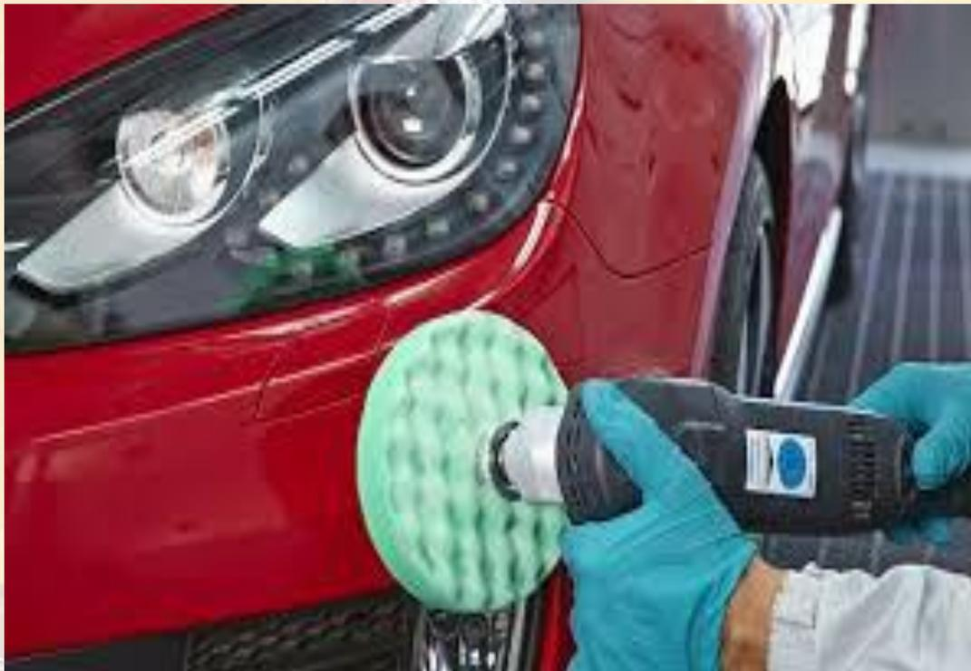
Se eliminarán las marcas circulares utilizando una almohadilla de espuma y un abrasivo fino. Mantener la almohadilla bien apoyada y limpiarla frecuentemente. Vigilar que no se produzca un calentamiento excesivo de la chapa.
